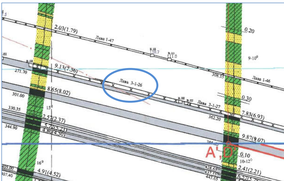
Рис. 22. Лава 3-1-26; почти половина всей мощности угольного пласта остается в почве
